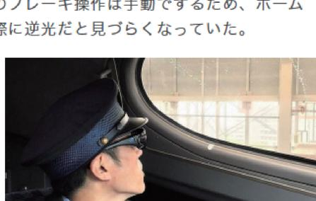
新幹線の停車時には窓枠部分の印を停止位置目標に合わせる（写真：JR西日本）
