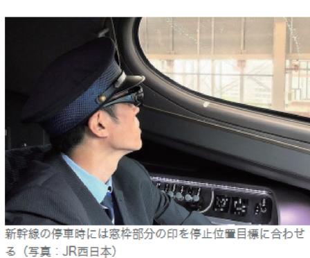
新幹線の停車時には窓枠部分の印を停止位置目標に合わせる（写真：JR西日本）
